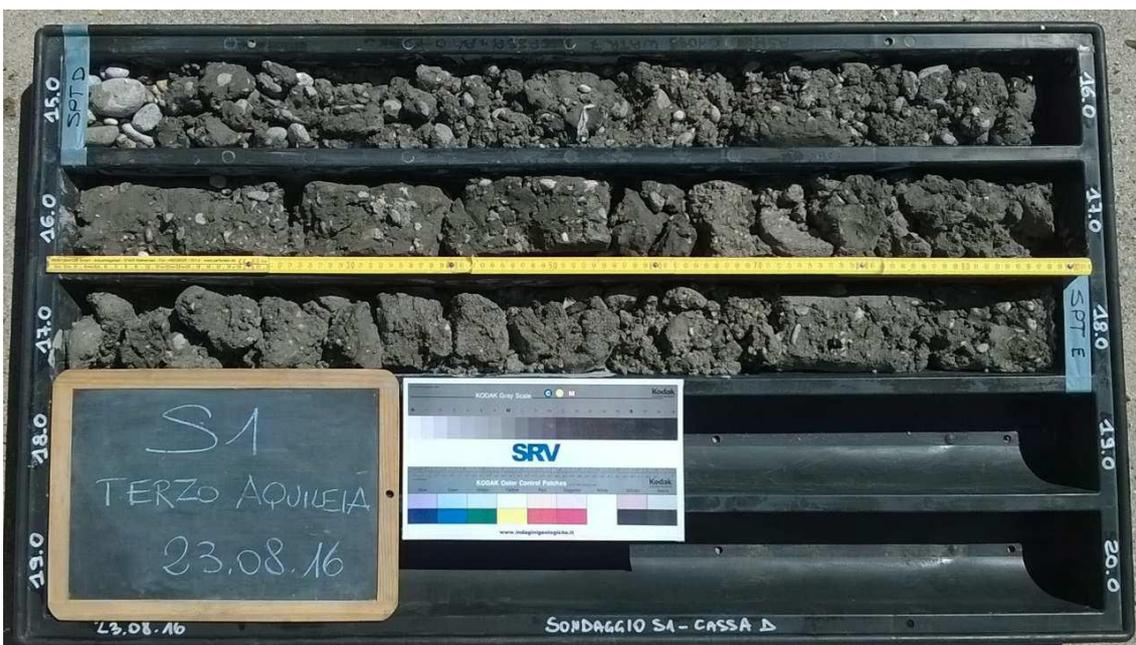
FOTO N° 4: SONDAGGIO S1, CASSETTA D: DA 15.0 A 18.0 METRI
